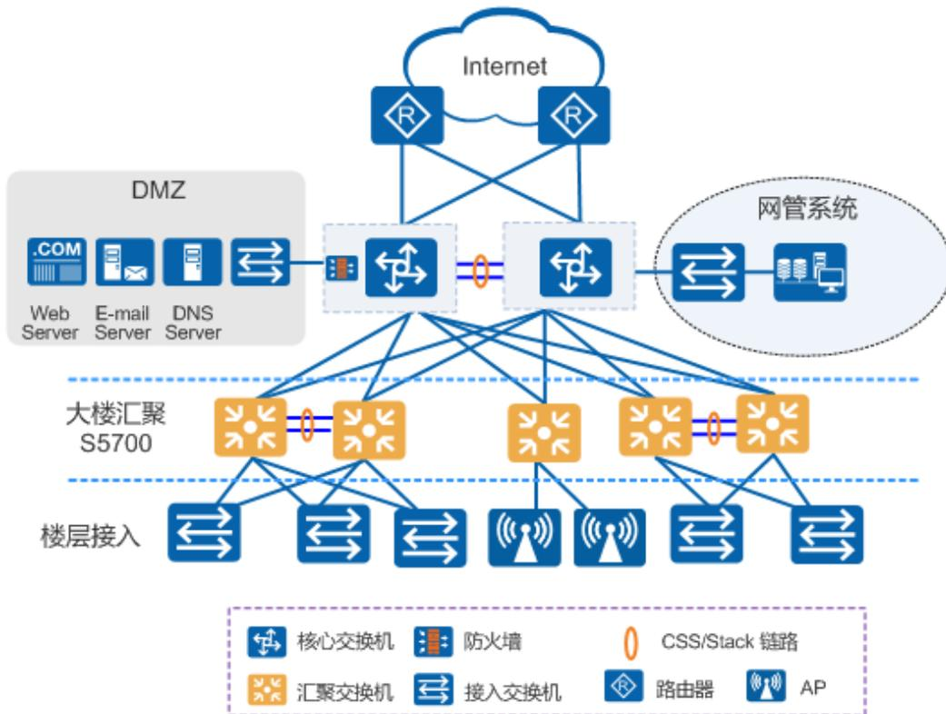
在企业网络和园区网中，CloudEngine S5731S-S 通过千兆/百兆接口接入交换机，提供高性能大容量交换，上行通过万兆光口接入核心交换机，构成万兆骨干、百兆到桌面的企业网全网解决方案，满足用户高带宽、多业务的需求。
