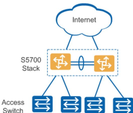
CloudEngine S5731S-S 使用智能堆叠技术，可以多台设备互相备份，保障核心设备的高可靠性。支持丰富的用户接入控制策略，用户集中管理，简化配置。
